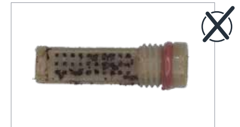
Filtre à eau sale et bouché
