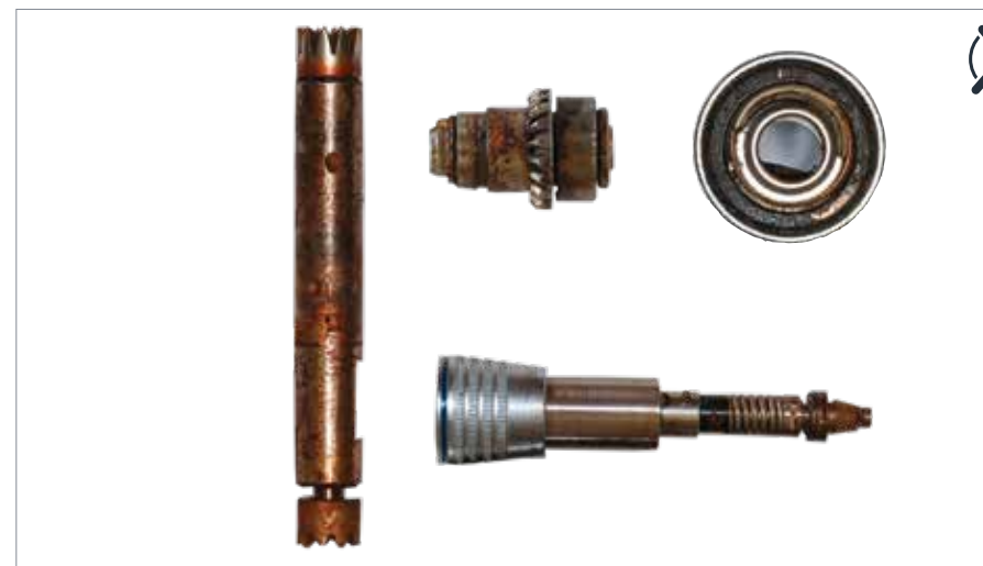
Pièces à main mal entretenues
